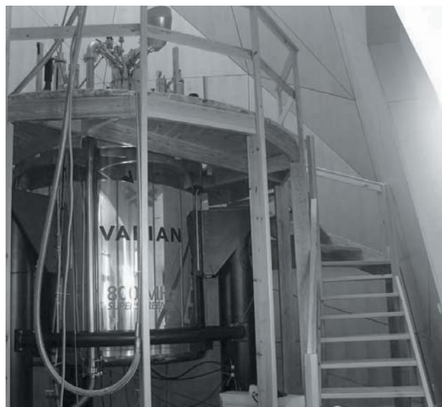
1. Ábra. A Szerkezetkutatási osztályon üzemelő 800 MHz-es NMR spektrométer mágnes.
