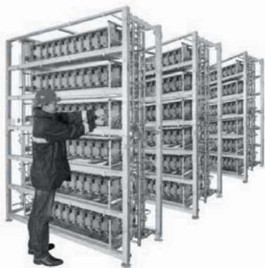
10. Ábra. Corning reaktorok párhuzamos elrendezése.
