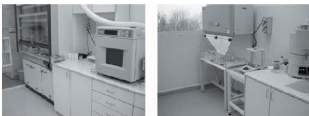
1. Ábra. Az MTA Izotópkutató Intézetben található mintaelőkészítő tisztalaboratórium berendezései; laminaris fülke és mikrohullámú roncsoló.
