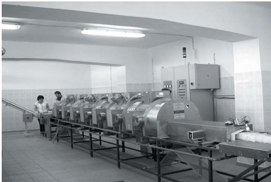
1.Ábra. A Karcagi rizshántolóban üzembe helyezett MDBT-20/4300 típusú üzemi mikrohullámú hőkezelő berendezés.
